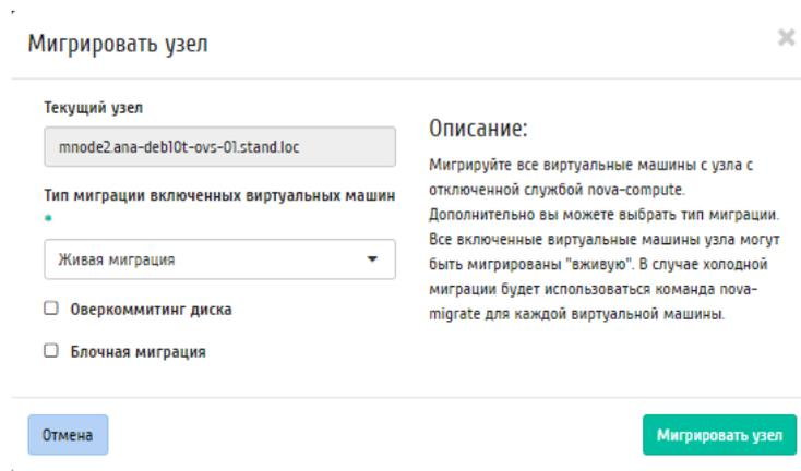
**Рисунок 39** Окно запуска миграции виртуальных машин с вычислительных узлов
